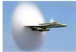
Die Schockwelle eines Überschallflugzeugs lässt Wassertropfen in einer kegelförmigen Wolke kondensieren.
